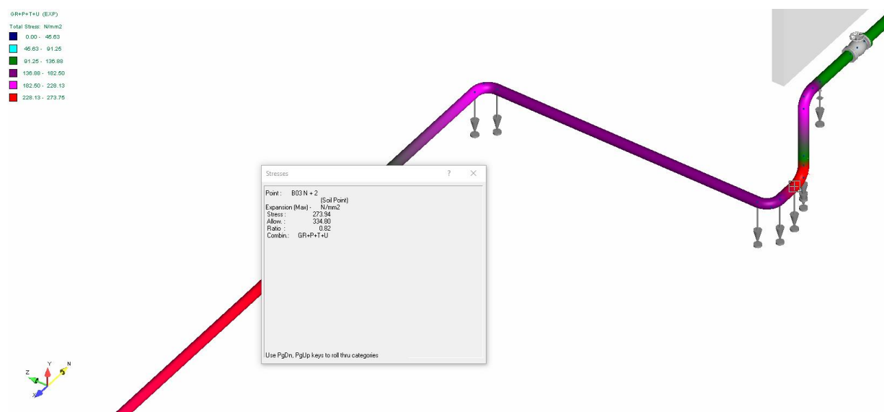
Рисунок 4 – Картина распределения напряжений по Мизесу. Выход с групповой замерной установкой кустовой площадки №8
